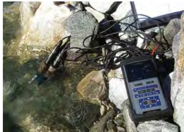
Sonde zur Messung wasserchemischer Parameter. Um Einblick in ökologische Zusammenhänge und Prozesse zu erhalten, braucht es auch Langzeit-Datenreihen zum abiotischen Lebensumfeld.
